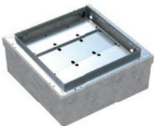
Während des Entsorgungsvorgang ist der Fundamentbehälter sicher zu verschließen. Die Sicherheitsplattform fährt mittels Kontergewichte selbsttätig hoch und schließt die Oberfläche sicher ab. Die Sicherheitsplattform ist nach Norm DIN EN 13071 bis 150 kg belastbar.
