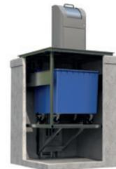
UFA, der Unterflur-Abfallbehälterlift, ist das variable Entsorgungssystem, das für Sauberkeit und Ordnung sorgt. Auch hier verschwinden die 240, 660 oder 1.100 Liter Abfallbehälter einfach unter der Erde - und mit ihnen unschöne Müllstandplätze. Ein elektrischer Antrieb sorgt für das schnelle und zuverlässige Heben und Senken der Abfallbehälter.
